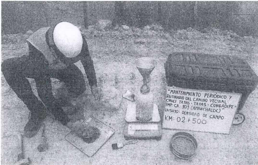
FIGURA 11. Ensayo de Densidad de Suelo en Campo en la progresiva Km 02+500
