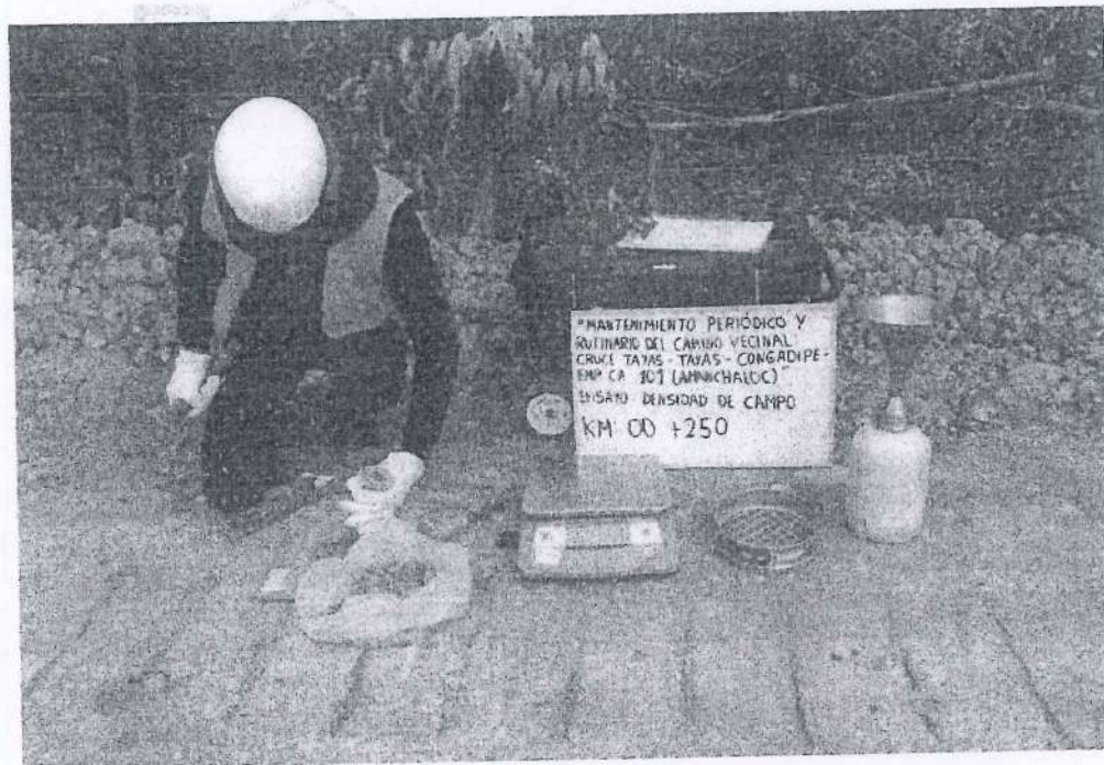
FIGURA 2. Ensayo de Densidad de Suelo en Campo en la progresiva Km 00+250
